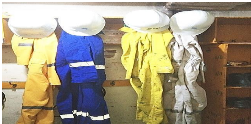
Gambar 3. Jumper locker ruang untuk menyimpan wearpack, safety helm dan safety shoes.
