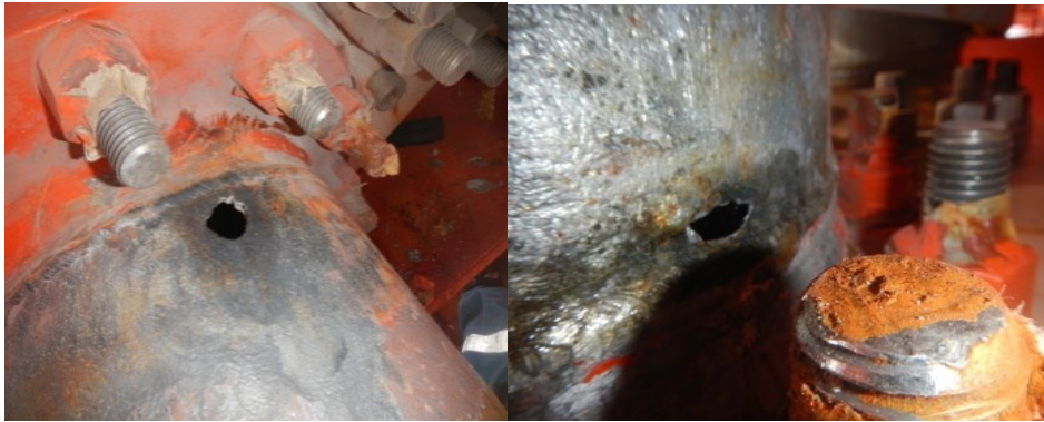
Gambar 4. Kebocoran Pipa Air Laut Yang Akan Masuk ke Dalam Propane Evaporator
