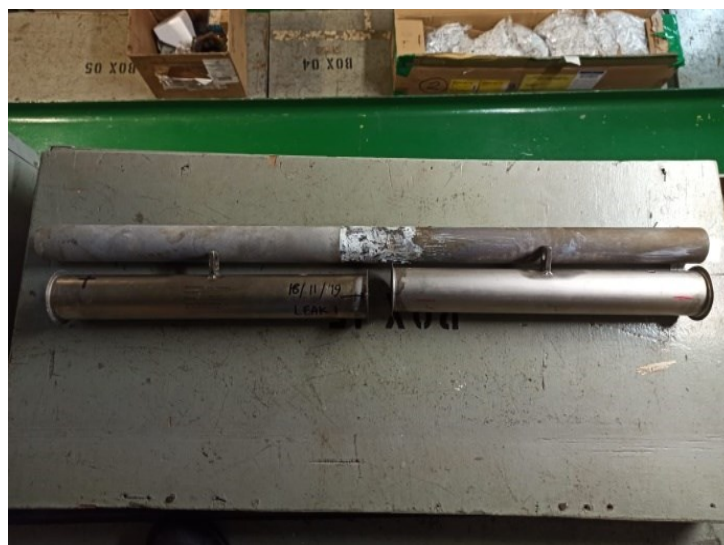
Gambar 5. Habisnya Coating Pada Inner Serta Bocornya Outter Cell Pada Chloropack
